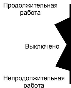
**Непродолжительный режим работы:** Нажмите выключатель со стороны страховочного ремешка и удерживайте. Детектор будет работать, пока выключатель находится в нажатом состоянии. При этом, для уверенности в работе металлодетектора, требуется крепко держать выключатель в нажатом положении.
