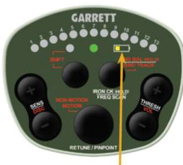
Индикатор разряда батарей
